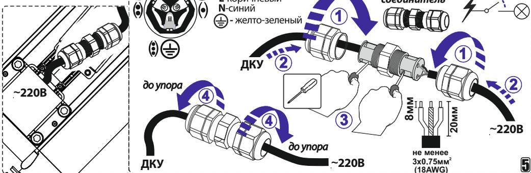
В модификациях с дополнительным выводом (димминг, АБ(аварийный блок) и т.д.) соответствующий провод имеет этикетку и его подключение необходимо производить согласно информации на ней.
