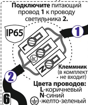
В модификациях с внешним аварийным блоком (АБ) дополнительно подключите внешний провод от линии непрерывной подачи напряжения к 3-х контактному аварийному клеммнику 1. Аварийная клемма 1 маркируется. Время полной зарядки АКБ светильника от встроенного зарядного устройства при полностью разряженном аккумуляторе от сети переменного тока напряжением 220 В, 12 часов. Время работы светильника, при полностью заряженном АКБ, не менее 1 часа.
